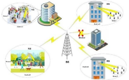
Hình 3. 1 Mô hình mạng tế bào với sự hỗ trợ của bề mặt phản xạ thông minh RIS
